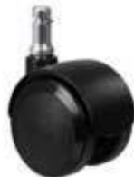
Rollen mit Belastungsbremse, die arretieren, wenn man sich setzt
